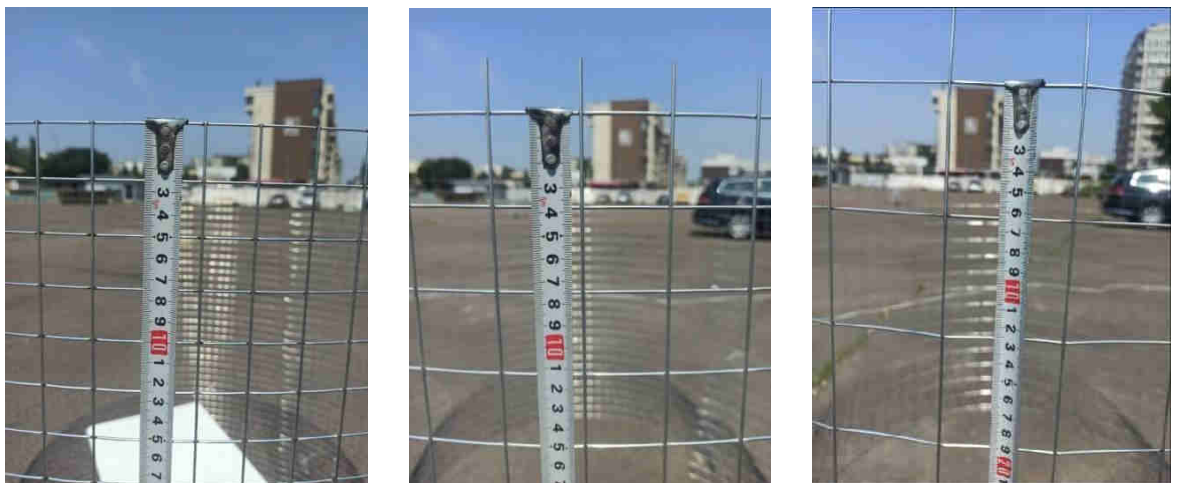
Рисунок 2.12 - Пример сетки с размером глазка 2.5x2.5 см, 3.5x3.5 см и 6x6 см
