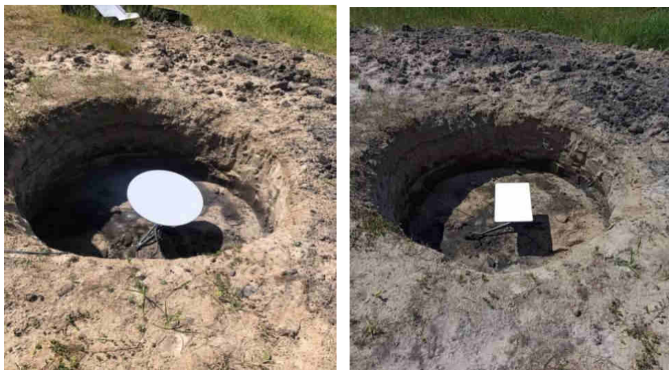
Рисунок 2.9 - Пример развернутых терминалов спутниковой связи Starlink защищенных от воздействия средств РЭБ методом углубления в землю
