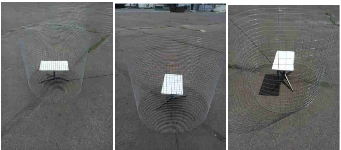
Рисунок 2.14 - Терминалы спутниковой связи Starlink защищенных «клетками Фарадея» в один слой сеткой для армирования с размером ячейки 2.5x2.5, 3.5x3.5 и 6x6 см
