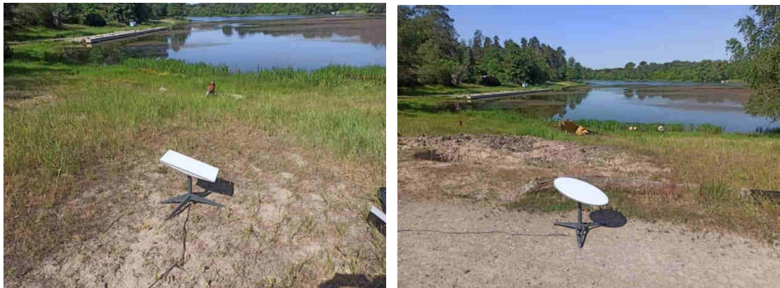
Рисунок 2.3 - Пример развернутых и настроенных терминалов спутниковой связи Starlink (разных поколений) к сети Интернет
