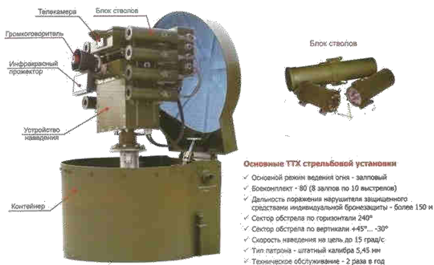
Рис. 7.4.3. Стрельбовая установка: состав и основные ТТХ.
