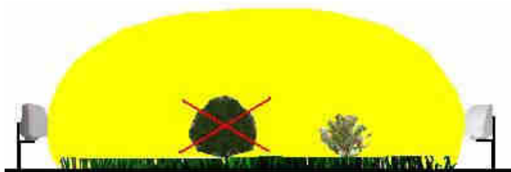
Рис. 5.3.6. Влияние на зону обнаружения радиолучевого СО крупных кустарников
