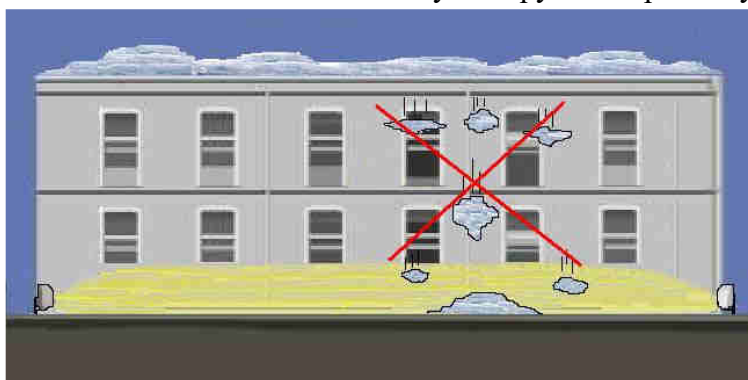
Рис. 5.3.8. Влияние на зону обнаружения радиолучевого СО обрушения снега
