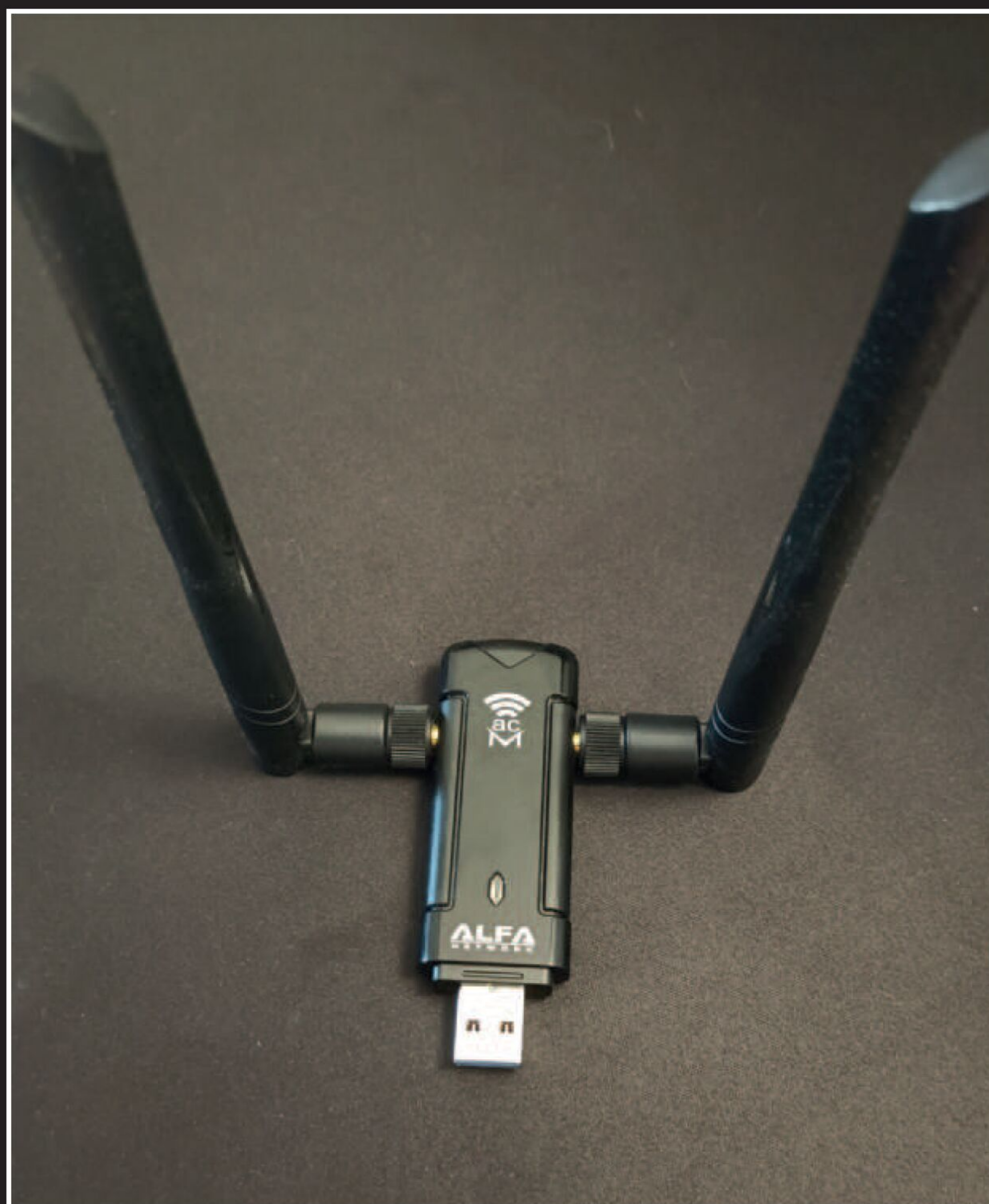
Alfa AWUS036ACM, usata per l'attacco evil twin (supporta VIF) (La trovate qui: https://short.tips/url/ac1200 ).
