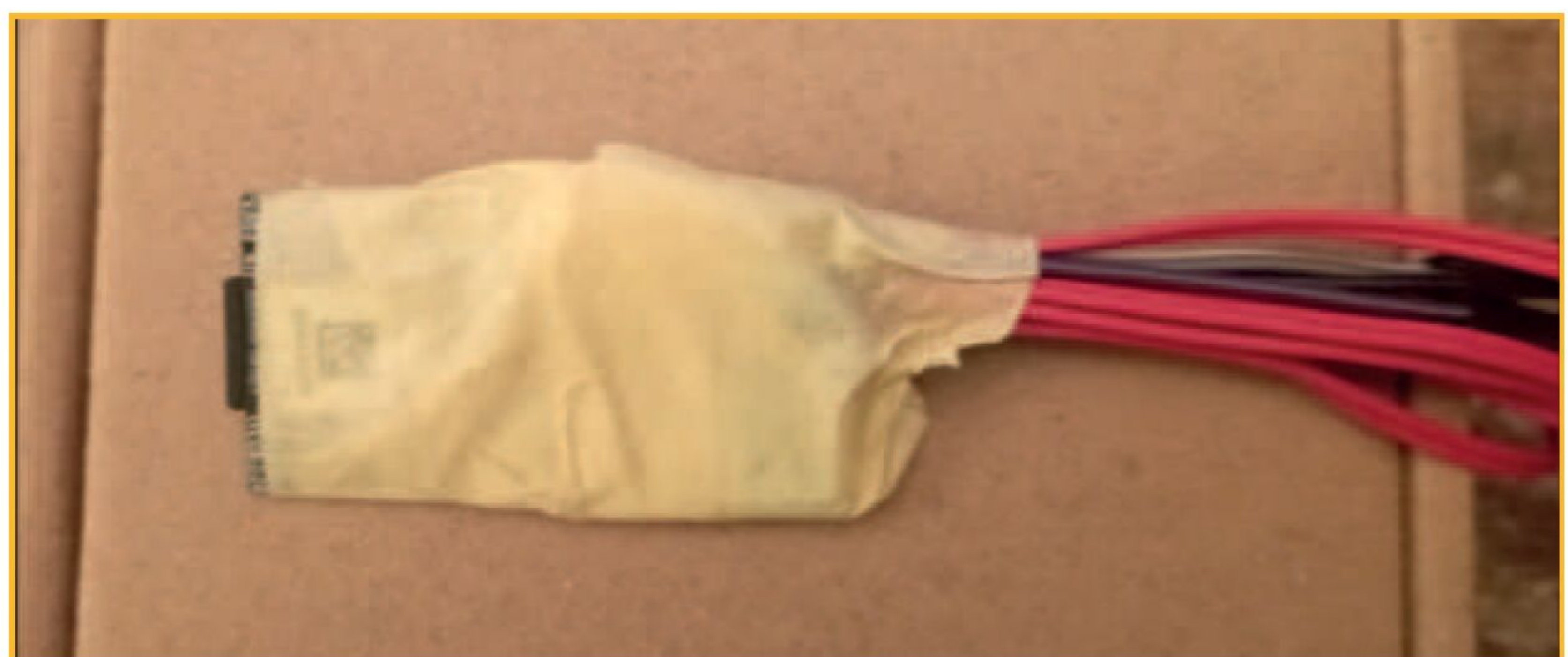
La nano coi fili saldati e ricoperta di scotch di carta a scopo isolante
