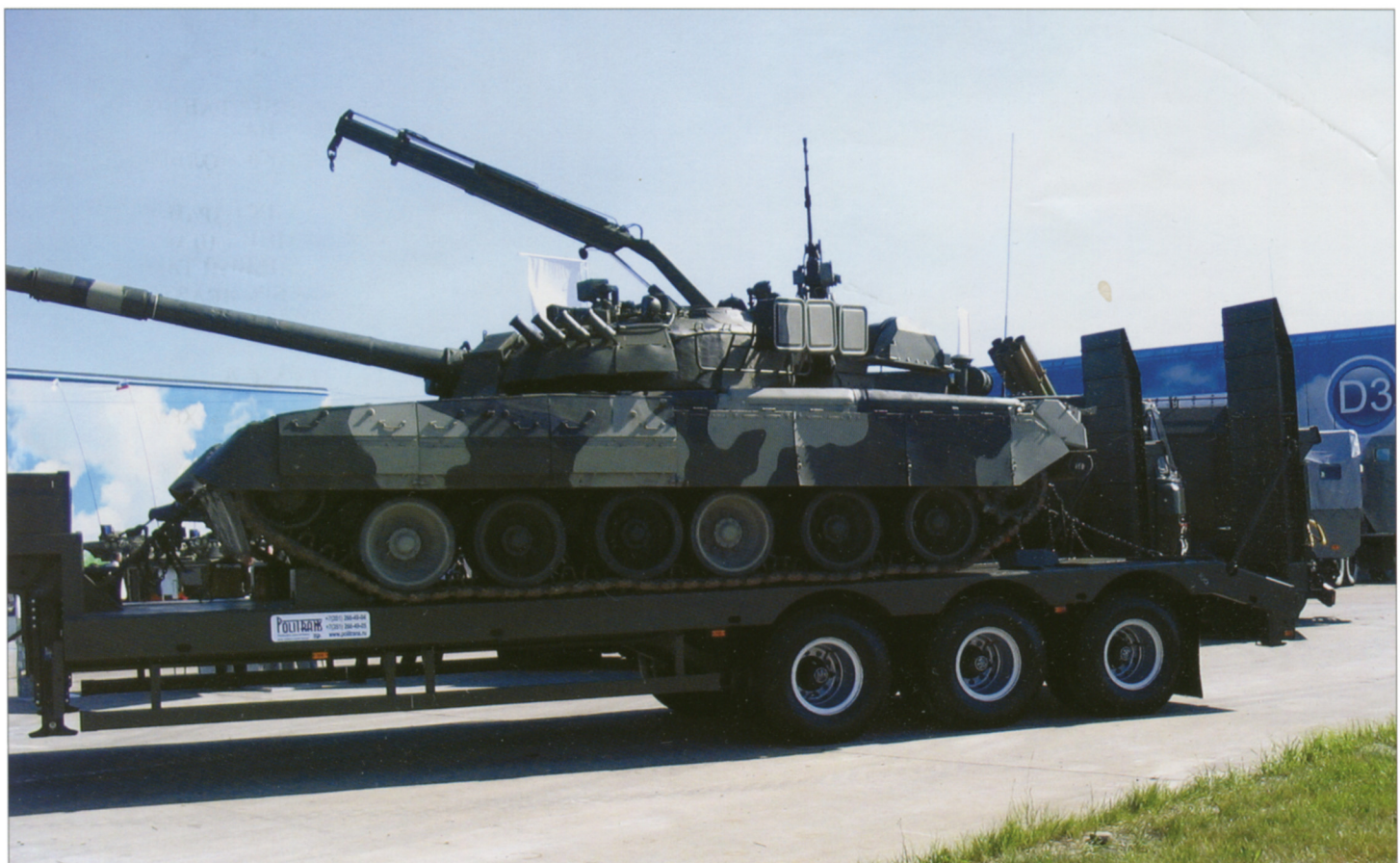
Танк Т-80У на полуприцепе-тяжеловозе ТСП-4161 подготовлен к транспортировке
