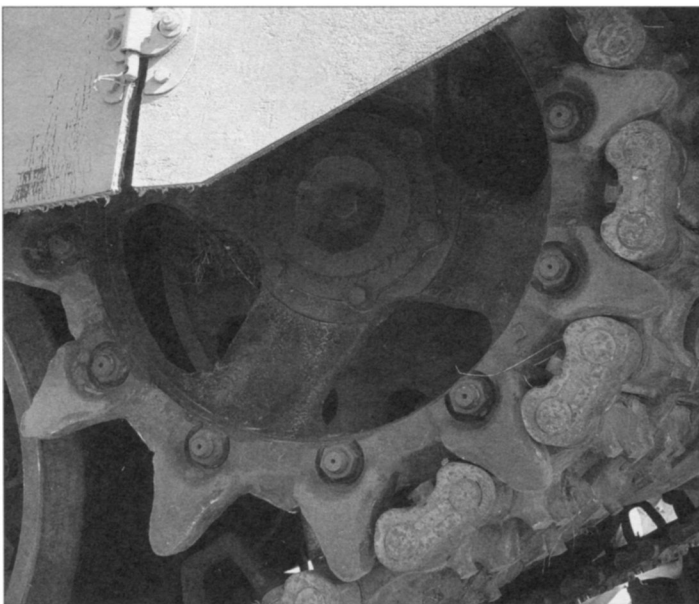
Вверху: двоянные опорные катки, выходной болт «длинного» торсиона и амортизатор Слева: ведущее колесо танка, над ним – защитные экраны ходовой части с соединительным замком
