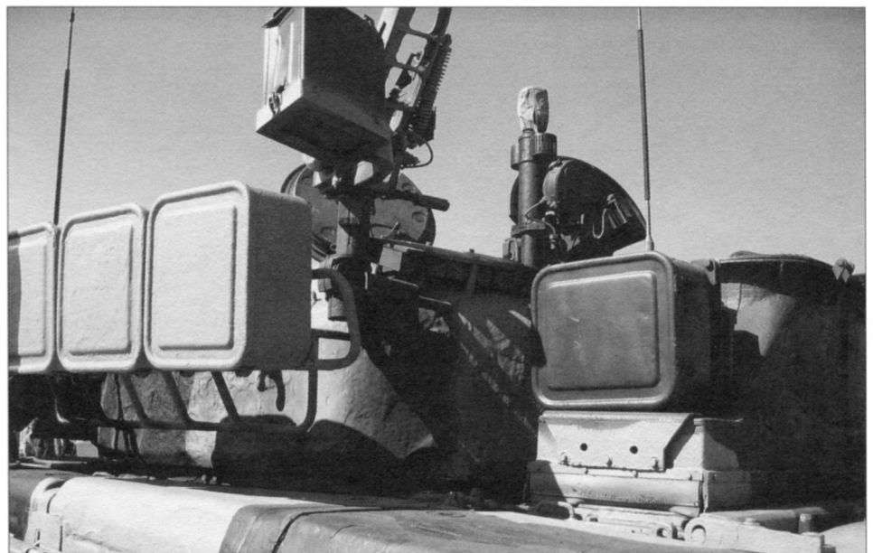
В левой части башни установлены на кронштейнах ящики имущества, в центре крыши – датчик ветра
