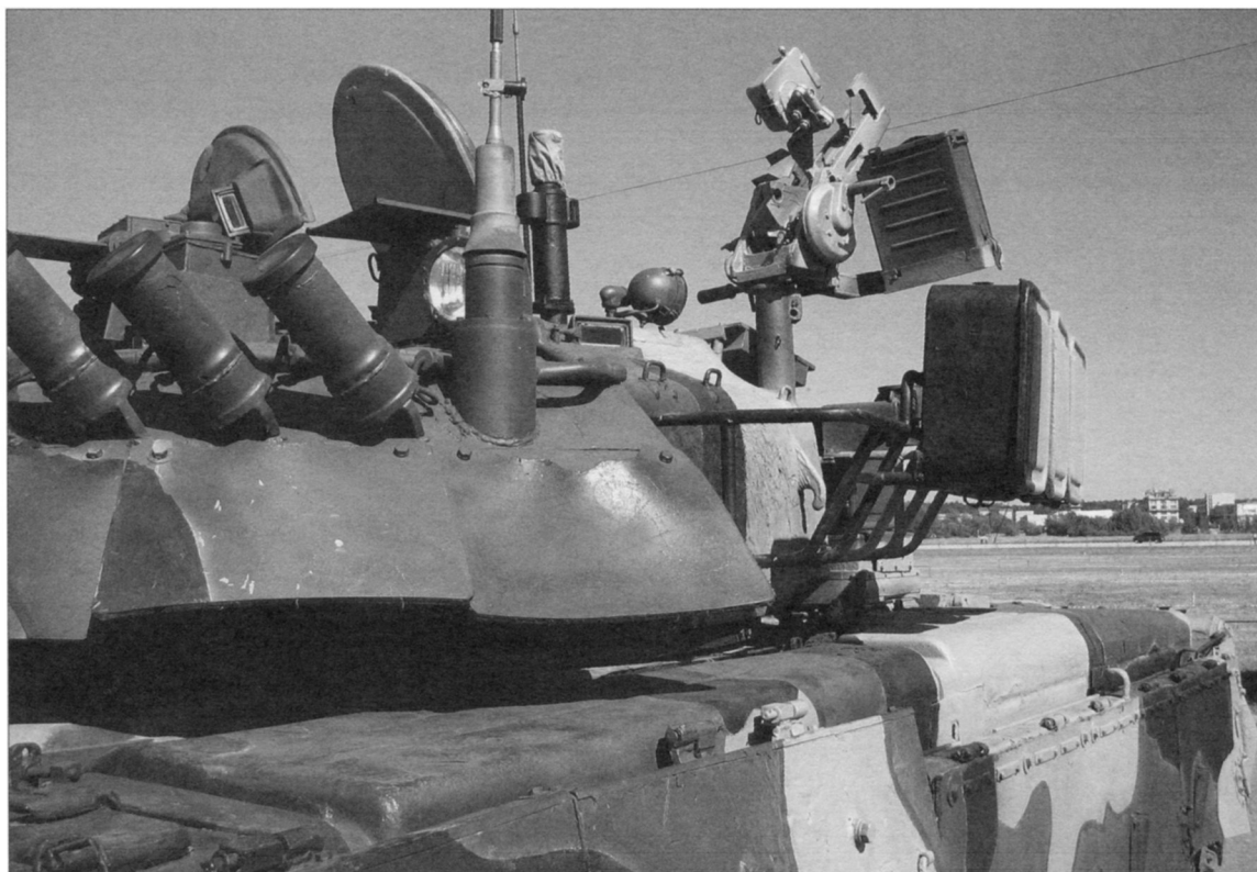
На левой стороне башни установлен блок пусковых установок дымовых гранат 902Б системы дымовой защиты «Туча», рядом с ними – фланец радиантенны, на корме видна задняя фара
