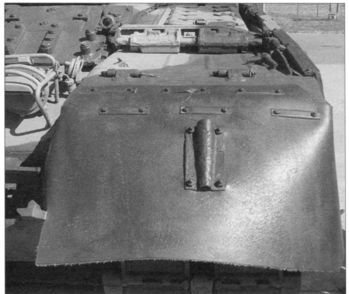
Вверху: гусеница танка с резинометаллическим шарниром и цевочным зацеплением. Ширина трака – 580 мм, число траков – 80. Масса гусеничной ленты – 1767 кг Справа: откидные грязевые щитки расположены спереди танка над направляющими колёсами
