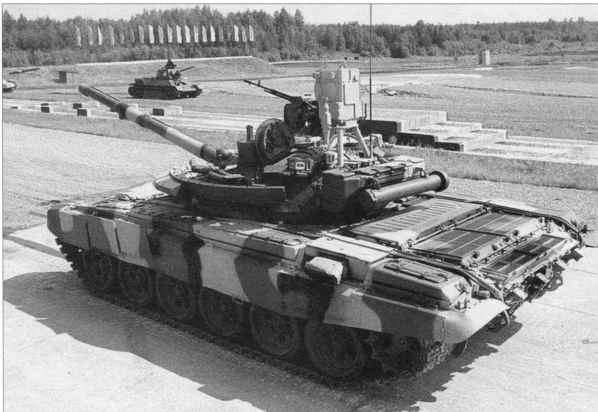
Танк с комплексом активной защиты «Арена-Э», действующим с помощью отстреливаемых защитных боеприпасов, встречающих противотанковые ракеты на траектории полёта
