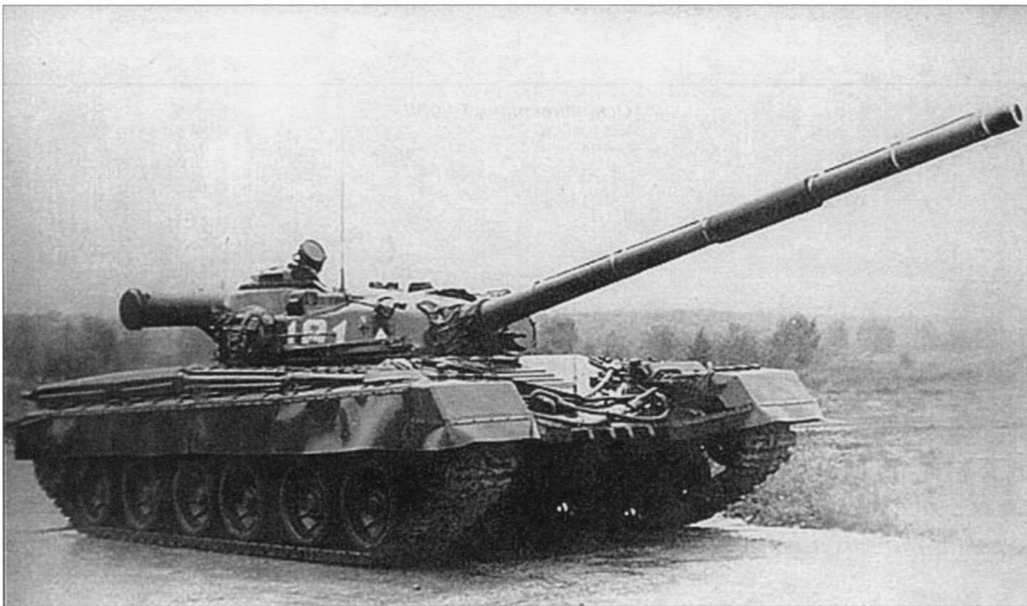
Танк Т-80 ранних выпусков с башней от Т-64А
