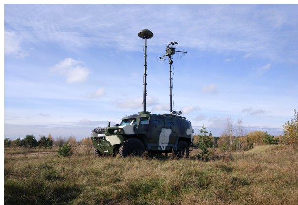
23.1: Станция радиотехнического подавления каналов БЛА AUDS [4] 23.2: Станция радиоэлектронной борьбы с беспилотными летательными аппаратами «Гроза-С» (на шасси МЗКТ-В1) РБ [65]
