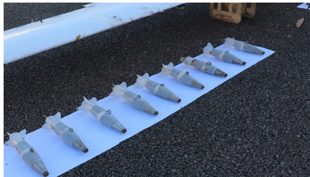
13.3: Сбрасываемые с БЛА боеприпасы калибром 0.4 кг
