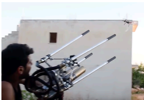
21.1: Накрытие БЛА сетью при перехвате с земли [13]
