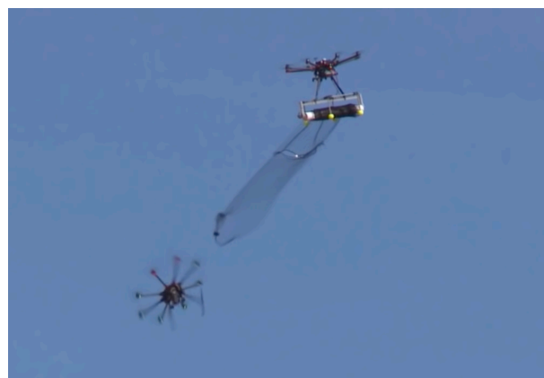
21.2: Опрокидывание БЛА сетью с другого БЛА при перехвате [31]
